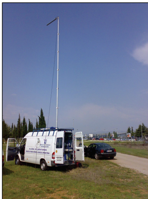
Slika 50 – Mobilna kontrolno-mjerna stanica
